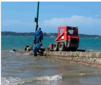
*Cet engin spécial motorisé (chargeuse) a été conçu spécialement pour circuler sur les cales et y déplacer les matériaux*
