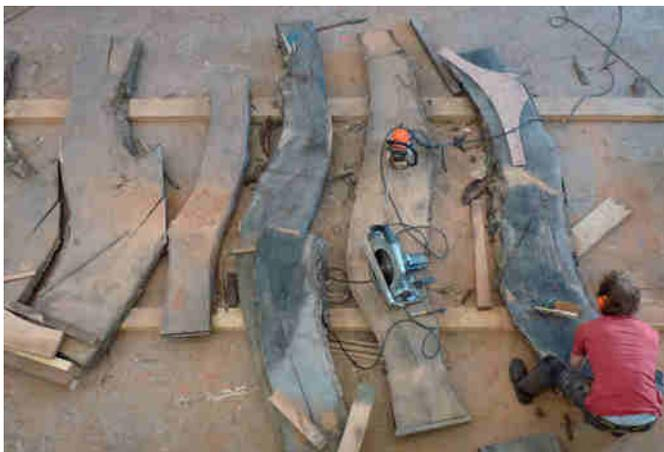
*Planches brutes issues d'un chêne et servant à la confection des différentes pièces de charpente d'un bateau.*
