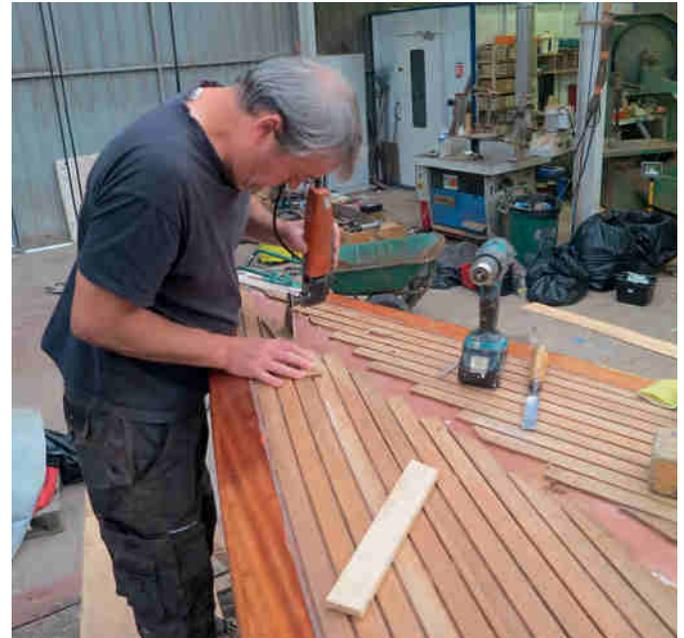
*Pierre travaille à la mise en place des lattes de pont sur un bateau de plaisance*
